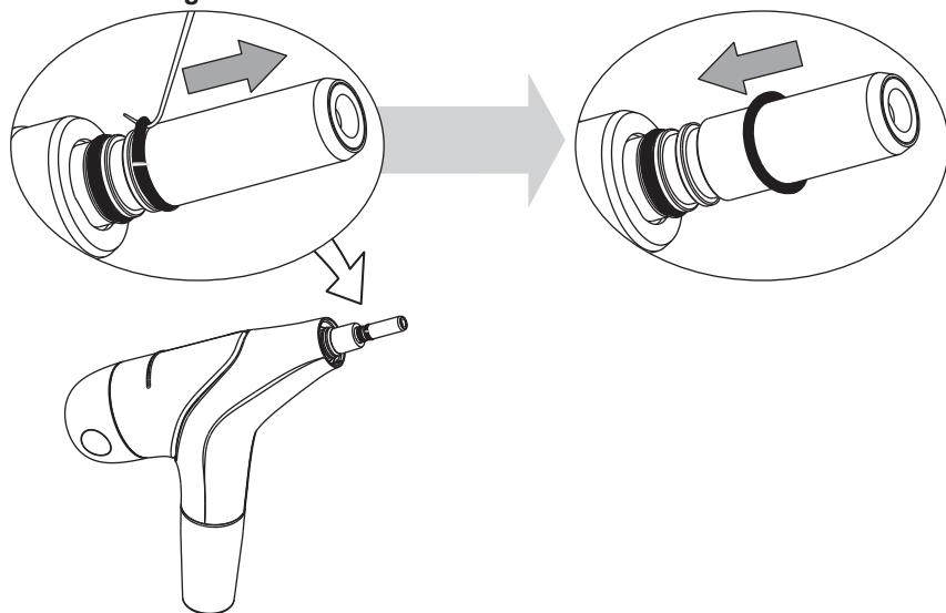
**!** Compruebe el estado de la rosca de la cámara de polvo y del tapón. La cámara de polvo está presurizada durante el uso. El estado de la cámara de polvo y del tapón es un factor de seguridad importante.
