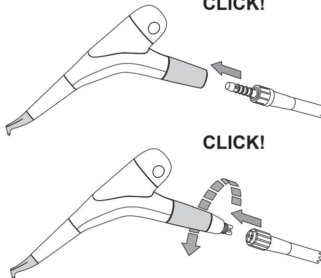
**⚠** El racor de turbina y el adaptador deben estar totalmente seco. La presencia de humedad en el racor de turbina puede provocar la obstrucción de los canales de circulación aire/polvo del aparato.
